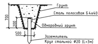
Установка вертикальных заземлителей
