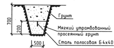
Установка горизонтальных заземлителей
